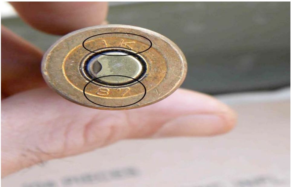
Photo 3 : Munition de calibre 12.7x108 mm. Les codes de marquage visibles sur le culot de la cartouche permettent uniquement de déterminer le fabricant (entreprise Igman Zavodf, située à Konjic en Bosnie Herzégovine) et l'année de fabrication (1987).
